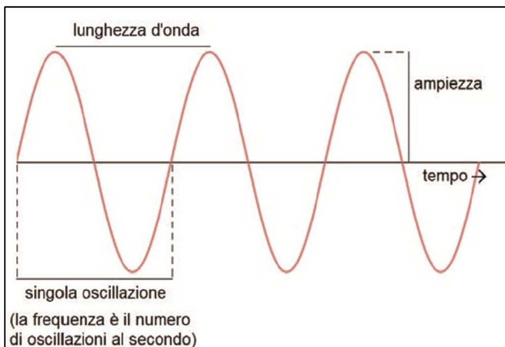
Figura 1 Parametri descrittivi dell'oscillazione meccanica che produce le vibrazioni (Inail - Dipartimento di medicina, epidemiologia, igiene del lavoro e ambientale)
